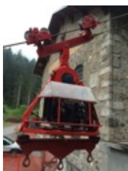
Carrello motorizzato tipo blondin, per la movimentazione ed il sollevamento dei carichi lungo una linea di teleferica da cantiere.
